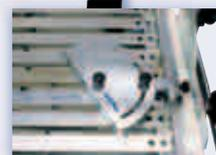
Seiten und Längsanschlag mit Gradeinteilung für Schrägschnitte
