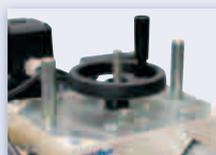
Stufenlose Höhenverstellung des Supports mittels Handrad
