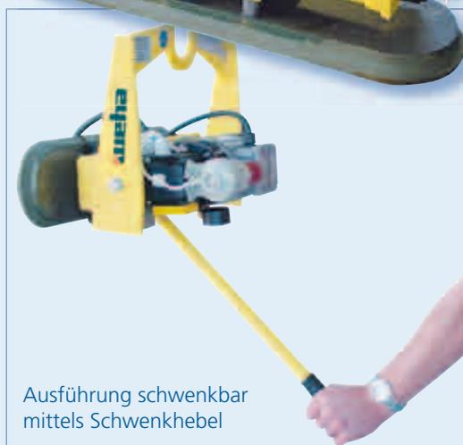
Ausführung schwenkbar mittels Schwenkhebel
